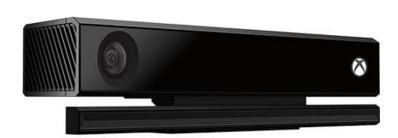
La Kinect est une caméra de temps de vol très performante qui permet de mesurer la vitesse de la lumière (et de faire de l'imagerie 3D). Le but de ce projet est de l'utiliser pour réaliser des expériences historiques de Foucault mais aussi des mesures de durée de photon vie en cavité, de principe de Fermat ou de détection dans les milieux diffusants
