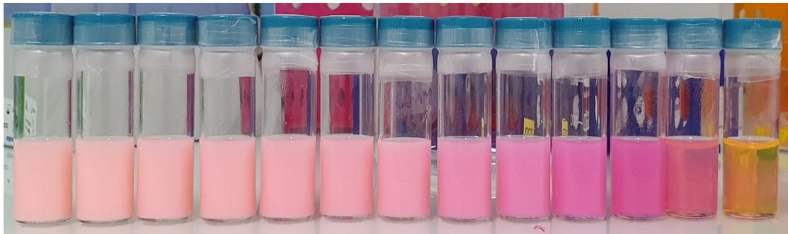
FIGURE 5 – Exemple des échantillons produits avec des différentes concentrations de sphères diffuseures
