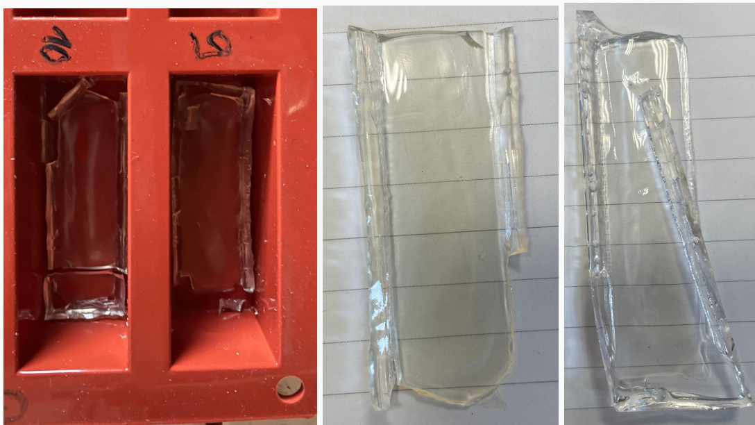
Figure 5. Moule utilisé pour la filmification (à gauche). Film de latex obtenu en séchant l'émulsion de polymérisation avec B1 (au centre). Film de latex cassé obtenu en séchant l'émulsion de polymérisation sans B1 (à droite).
