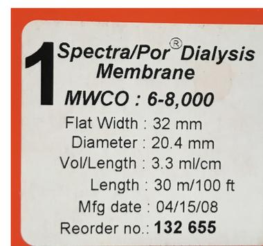
FIGURE 5 – Caractéristiques des boudins de dialyse utilisés
