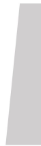
Fig. 2 : Forme d'une ailette intérieure de gobelet. La hauteur est environ celle du gobelet, la largeur est de l'ordre de 1 à 2 cm de façon à pouvoir maintenir la balle sans la contraindre.
