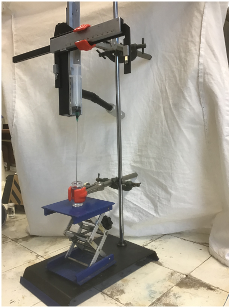
(a) Montage employé pour injecter une goutte de ferrofluide dans le gel.
