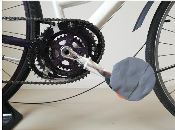
Figure 2 : Bande réfléchissante fixée sur la pédale
