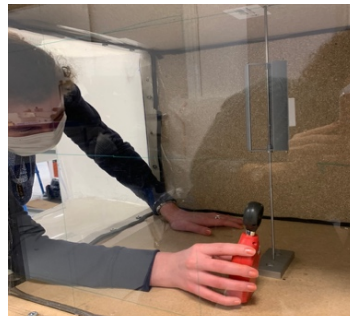
Mesure vitesse du vent grâce à un anémomètre
