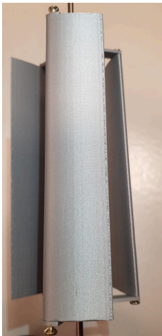
Éolienne en PLA
