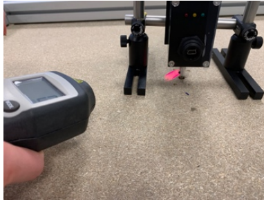
Mesure de la vitesse de rotation de l'éolienne avec un tachymètre
